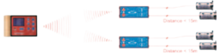
Four ZEROTRONIC sensors connected to a BlueMETER SIGMA by means of two BlueTC Vier ZEROTRONIC-Sensoren über zwei BlueTC mit BlueMETER SIGMA verbunden
