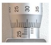
**Die Differenz ist: 21.81 -7.83 = <u>13.98 mm</u>** = Betrag der Höhendifferenz zwischen den beiden Messzylindern.
