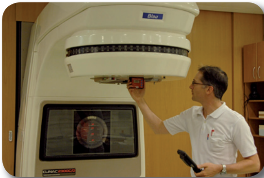
Setting Gantry 0° with CLINOTRONIC Plus Portalwinkel 0° mit CLINOTRONIC Plus setzen
