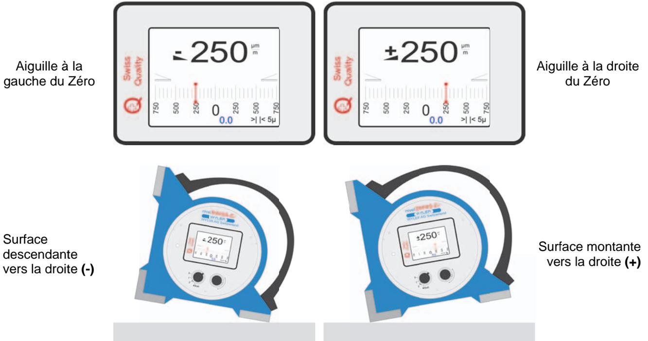
Il est important de tenir le nivelSWISS-D absolument vertical pendant le mesurage. Sinon la valeur indiquée peut différer de la valeur effective (erreur de Twist). La fiole transversale incorporée vous permet de contrôler la position verticale de l'instrument à chaque instant.
