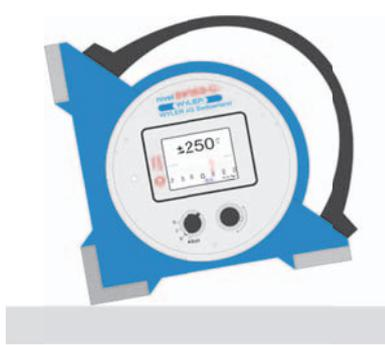
Per consentire la misurazione lo strumento nivelSWISS-D deve essere tenuto in verticale, altrimenti il valore mostrato sul display potrebbe essere discordante da quello effettivo (cosiddetto errore di Twist). Mediante una livella a fiola integrata è possibile controllare in ogni momento che l'apparecchio di misurazione sia in posizione verticale.
