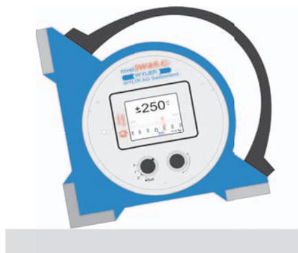
Zum Messen muss das nivelSWISS-D vertikal gehalten werden. Ist das nicht der Fall, kann der Anzeigewert vom echten Wert abweichen (Twist-Fehler). Mittels der eingebauten Querlibelle kann die vertikale Lage des Messgerätes jederzeit überprüft werden.
