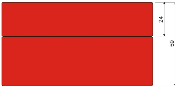
BlueTC mit Batteriefach Ansicht von der Seite
